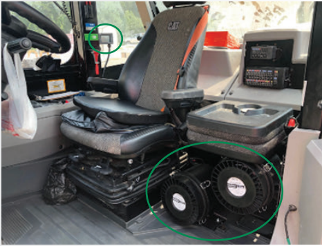
INTERIOR CABINA UNIDADES DE RECIRCULACION: RESPA FFX2 UNIDADES DOBLES INSTALADAS MONITOR: RESPA ADVISOR+
